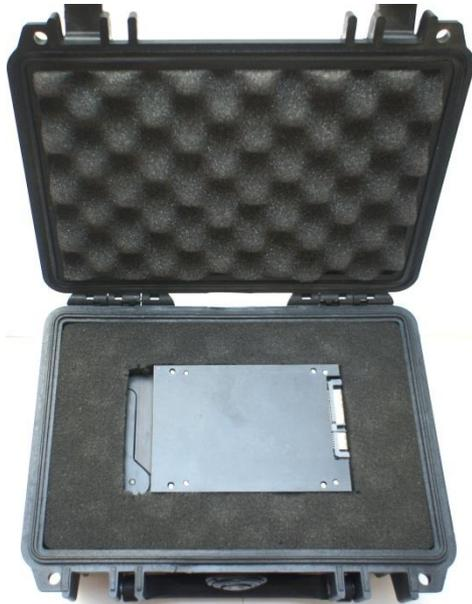
Запись оригинала данных наблюдательного полета осуществляется на съемный носитель. Кроме того, в алгоритме записи оригинала данных на съемный носитель реализована запись несмещённых уменьшенных (обзорных) изображений, которые одновременно в ходе наблюдательного полета отображаются на мониторе оператора.
