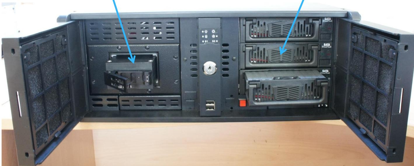
\* - Сервер обработки имеет возможность одновременной записи данных наблюдательного полета в формате ФОЦДОН на пять носителей информации (три внутренних и два внешних накопителя с интерфейсом USB 3.0) со средней скоростью около 60 МБ/сек на каждый.
